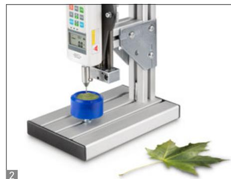
Banco di prova manuale per prove precise di trazione e compressione nell'intervallo fino a 100 N
