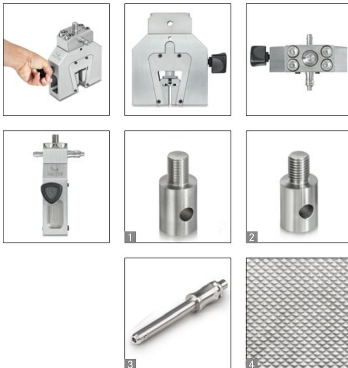
Morsetto a cuneo a regolazione rapida per prove di trazione per il campo di forza fino a 50 kN
